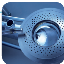
TALÍŘ HOŘÁKU SE SPODNÍM PODÁVÁNÍM Velmi stabilní primární systém spalování s přepadem popela bez pohyblivých částí a horkovzdušné zapalování s příkonem pouze 250 W
