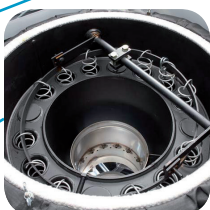
AUTOMATICKÉ ČIŠTĚNÍ TEPELNÉHO VÝMĚNÍKU Vysoká účinnost kotle s nízkou spotřebou pelet
