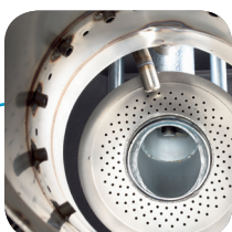
OTEVŘENÝ SYSTÉM SPALOVÁNÍ Díky kruhové sekundární nerezové spalovací jednotce, s teplotou dřevního plynu kolem 800°C, dochází k dokonalému spalování. Tím je dosaženo nízkých emisí, rychlé reakce a dlouhé životnosti.
