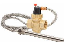
La caldaia a legna è dotata di una valvola di scarico termico. Se la temperatura supera un valore critico, la valvola di scarico termico viene attivata.
